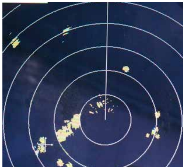
Radarskärm med ekon, avståndsringar och stävmarkeringen som visar föröver.
