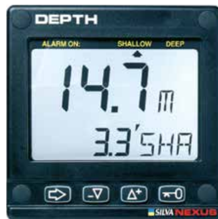
Digitalt ekolod med aktiverat minsta-djuplarm (SHA = Shallow).
