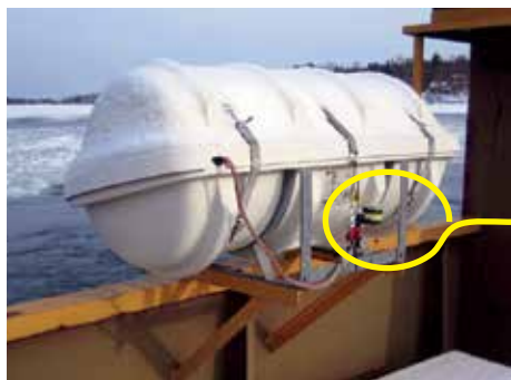
Lossa sliphaken så är flottens surring lossad.
