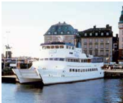
Katamaranskrov är en annan lösning för att skapa stabilitet genom bredd.
