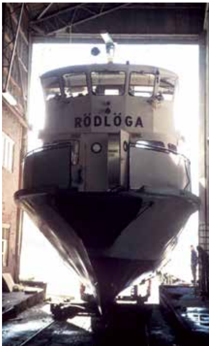
Ett högt och smalt fartyg måste ha tillräckligt mycket lågt placerade vikter (maskiner, barlast) för att bli stabilt.
