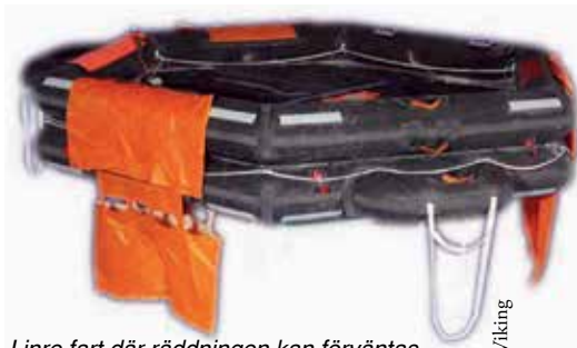
I inre fart där räddningen kan förväntas komma tämligen fort, accepteras flottar som inte behöver vändas och som saknar tak, s k ORL.
