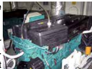
Förhindra brand t ex med inkapslade bränslerör.
