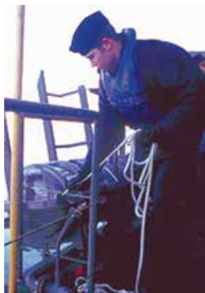
Lossa sliphaken så är flottens surring lossad.
